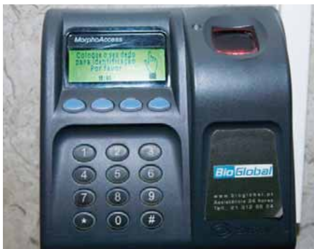
Leitores para abertura das portas, com banda magnética e dados biométricos, e portas de segurança de acesso à zona de alta segurança.
